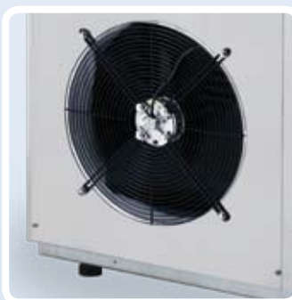
Dauerhaft von Korrosionserscheinungen freie Ummantelung aus Peraluman, Axialventilatoren mit Außenrotor und niedriger Drehzahl, elektronische Kontrolle über Mikroprozessor und Vibrationsdämpfer aus Gummi.
